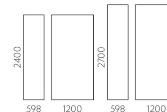
L'assemblage Hydrolock® réduit la surface finie de 18 mm soit 2400 mm x 1200 mm pour 2400 mm x 1182 mm. Des panneaux à bords droits sont aussi disponibles.
